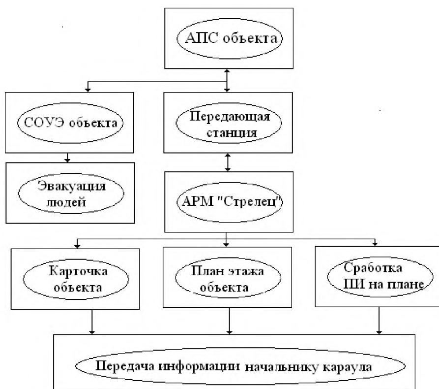
Рис. 3. Алгоритм передачи информации от АПС объекта начальнику караула
