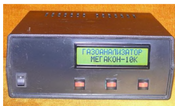
Рис. 2. Внешний вид газоанализатора «Мегакон»
