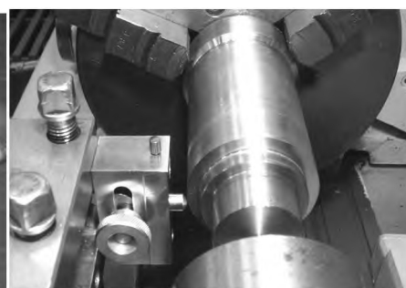
Рис. 2. Фотография обработки детали насоса алмазным выглаживанием на токарном станке
